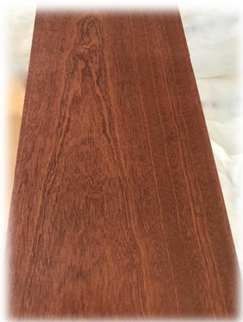
Abbildung 2; Mahagonifurnier in matt beschichtet mit dem obigen System (Primer, Sealer, Basecoat und Schutzlack).
